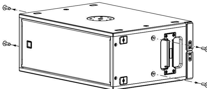
2. Posizionare la staffa sopra al diffusore e avvitare al mobile con le quattro viti M10 in dotazione.
