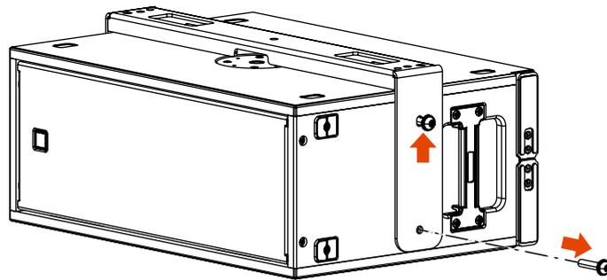
2. Posizionare le link bar su entrambi i lati facendo passare la vite superiore attraverso l'asola circolare della staffa; dopodichè riavvitare la vite M10 inferiore (non stringere ancora le viti).
