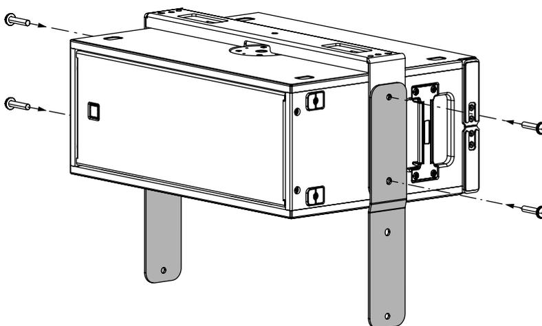
3. Posizionare il secondo subwoofer in configurazione cardioid e avvitarvi la staffa con le viti M10 in dotazione.
