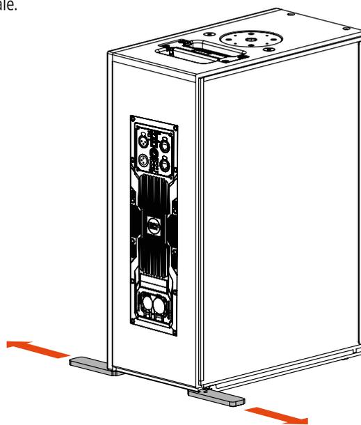
Quando utilizzato in posizione verticale, estrarre le due placche in plastica dal lato inferiore per aumentare stabilità e sicurezza.
