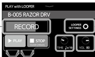
Tocate per aprire la schermata d'impostazione del looper. La funzione UNDO può essere commutata su ON/OFF ed è possibile impostare il metodo di stop e la posizione del looper
