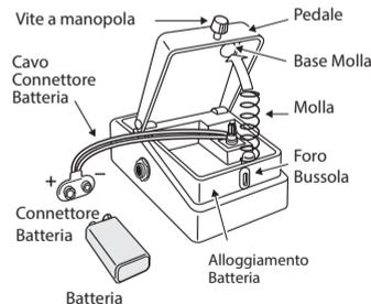
2. Rimuovete la batteria vecchia dal suo alloggiamento e staccate il connettore ad essa collegato.
